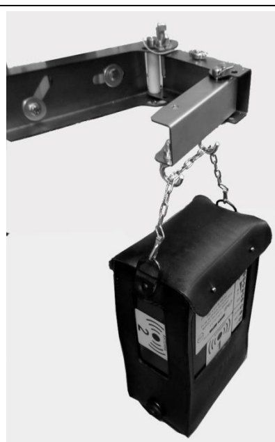
Рис. 5 Установка в чехле в повороте выработки
