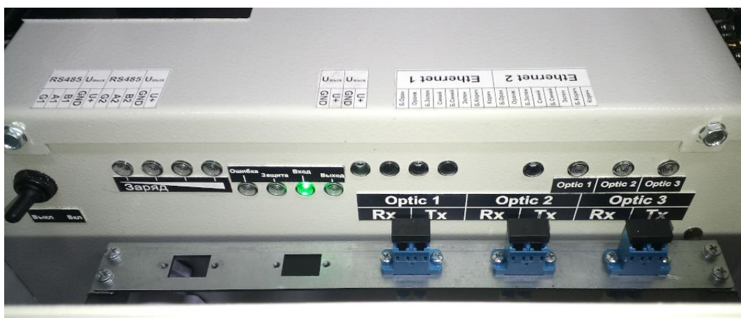
Рис. 3 Индикаторы и выключатель блока питания, разъемы и индикаторы оптоволоконной связи
